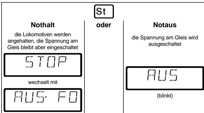
Werkseinstellung ist Nothalt, also Anhalten der Loks bei eingeschalteter Spannung am Gleis. Wie Sie die 'St' - Taste einstellen, sehen Sie im Abschnitt "SET\_1: Funktionsweise der 'Stop' - Taste einstellen".
