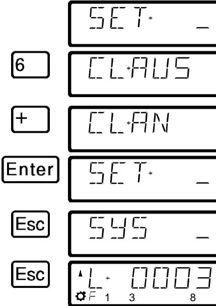
Die gegenwärtige Einstellung wird angezeigt. (AUS ist Werkseinstellung, es können keine Adressen aus dem Zentralenspeicher gelöscht werden)
